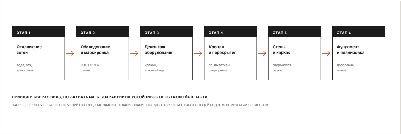
Рис. 2. Шесть этапов демонтажа: от отключения сетей до планировки и вывоза отходов.
